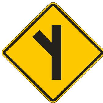
**Figura 101 – Sinal A-10b – Entroncamento oblíquo à direita**
