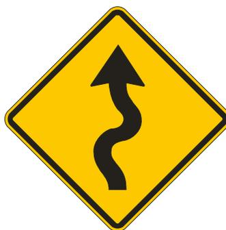
**Figura 89 – Sinal A-3b – Pista sinuosa à direita**
