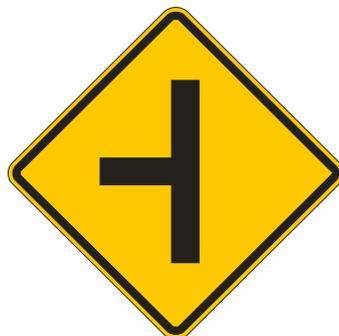
**Figura 96 – Sinal A-7b - Via lateral à direita**
