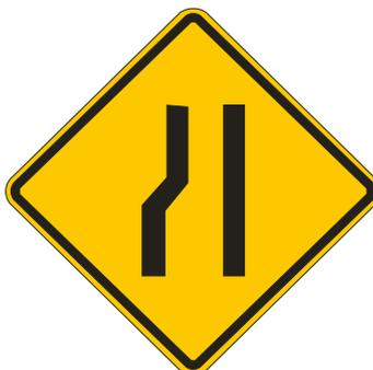
**Figura 116 – Sinal A-21c – Estreitamento de pista à direita**
